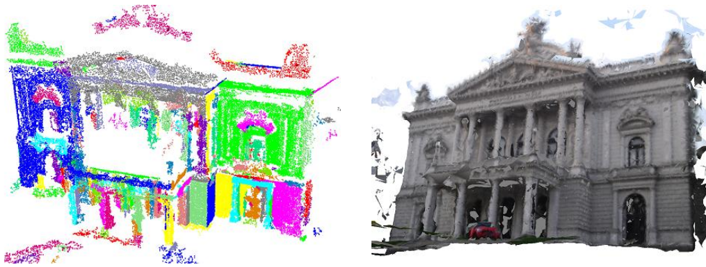
Obrázek 2: Segmentace budovy na rovinné shluky bodů a polygonální síť (164k trojúhelníků)
