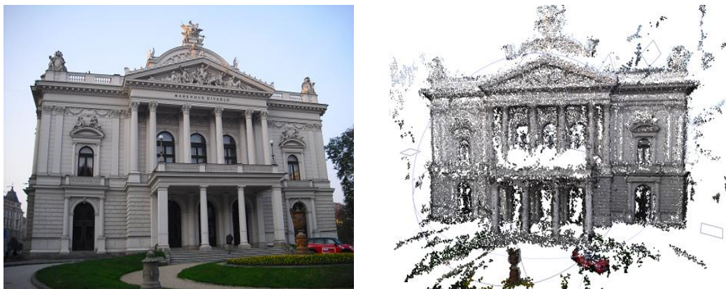
Obrázek 1: Jedna z 55 použitých fotografií a zrekonstruované mračno 87k bodů
